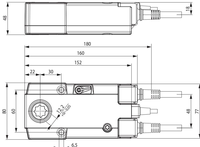
**Электропривод для управления противопожарными
