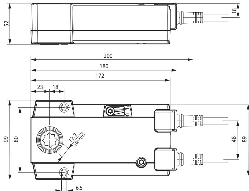
**Электропривод для управления противопожарными
