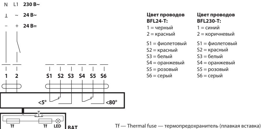
Tf — Thermal fuse — термопредохранитель (плавкая вставка)
